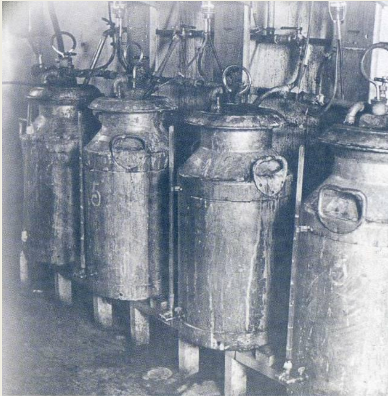
Установка для получения пенициллина в лаборатории Х. Флори.
