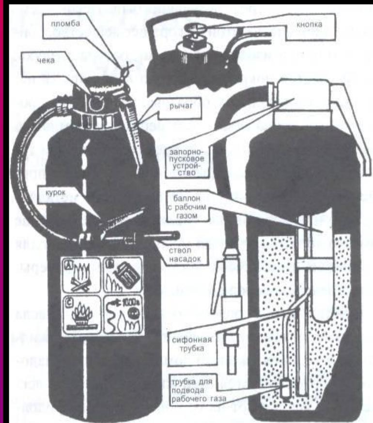
зом. Газ поступает в корпус с огнетушителя и создает избыточное давление. Порошок вытесняется по сифонной трубке к стволу. Огнетушащее вещество можно подавать порциями нажатием на курок ствола. Попадая на горящее вещество, порошок изолирует его от кислорода воздуха.
