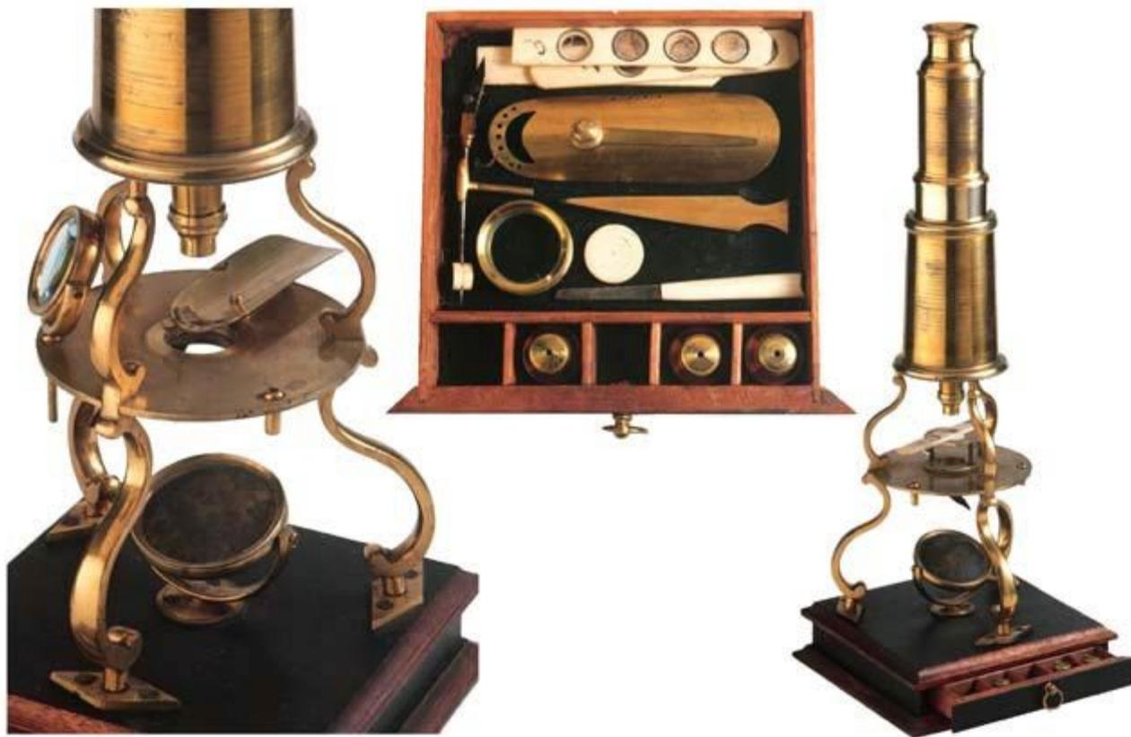
Идея Х.Г. Гертеля об освещении прозрачных объектов снизу с помощью зеркала впервые воплотилась в жизнь в микроскопах Э. Кельпепера. С 30-х гг. XVIII в. он начинает выпускать треножную модель сложного микроскопа, под столиком которого располагалось зеркало. В состав микроскопа входило несколько объективов, дававших увеличение от 25 до 275 раз.
