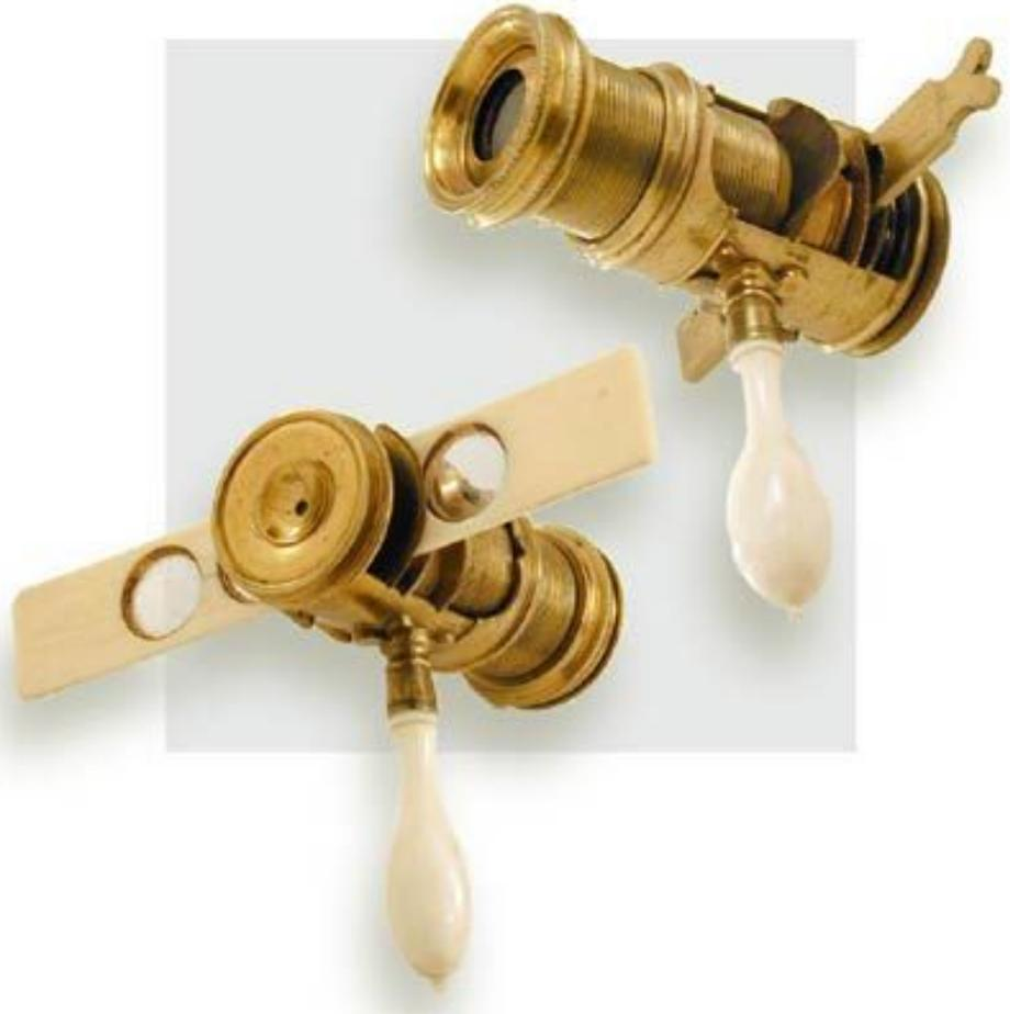
В первой половине XVIII в. широкое распространение получил так называемый "ручной" или "карманный" микроскоп, сконструированный английским оптиком Дж. Вильсоном. "Ручные" микроскопы пользовались большой популярностью у любителей-микроскопистов.
