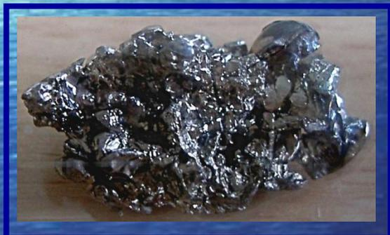
Металлический барий получают из оксида восстановлением алюминием в вакууме при 1200-1250°C:
