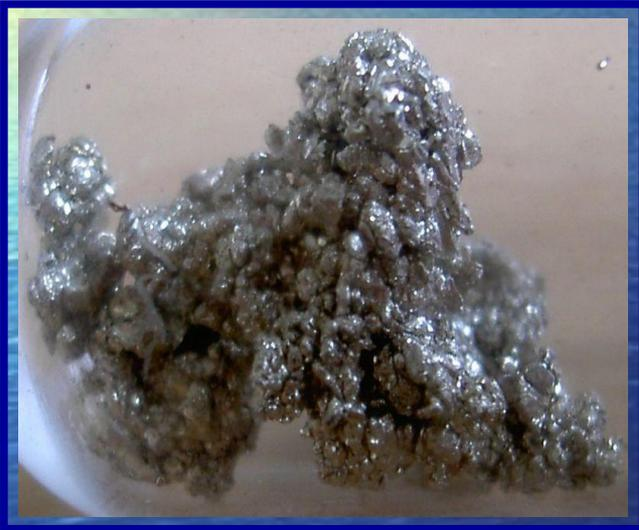
Основным промышленным способом получения металлического стронция является термическое восстановление его оксида алюминием. Далее полученный стронций очищается возгонкой.
