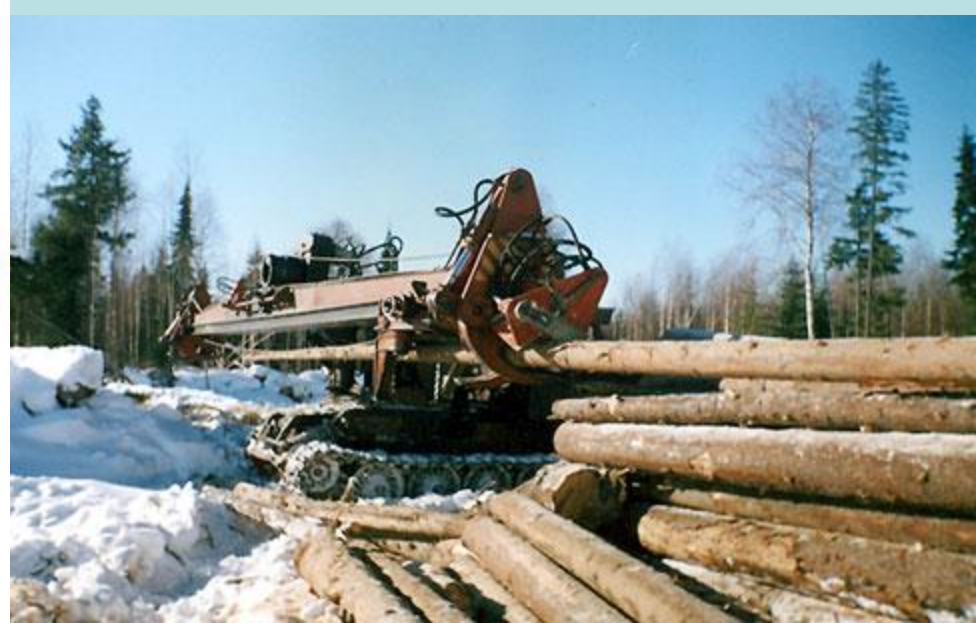
Сучкорезно-раскряжевочная машина ЛМ-1
