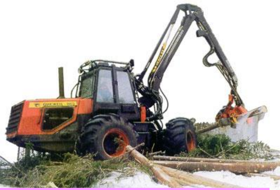
Валочно-сучкорезно-раскряжевочная машина ТЛК4-15
