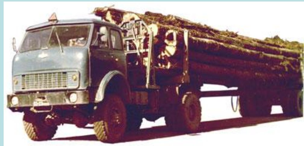
Лесовозный автомобиль-тягач МАЗ-509А
