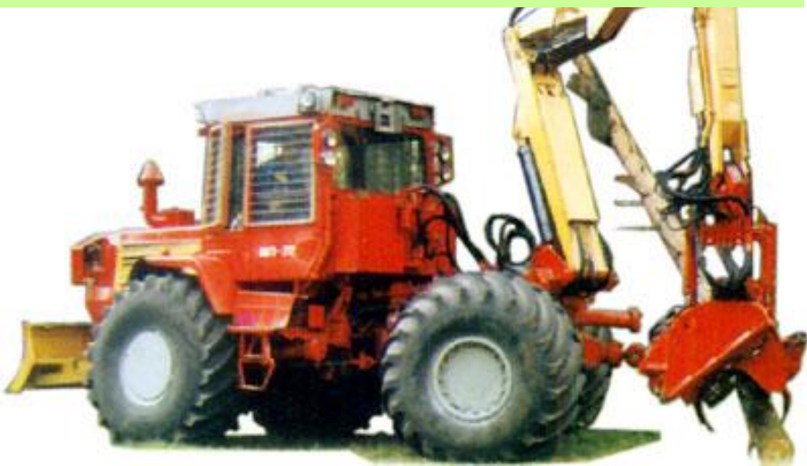
Валочно-сучкорезно-раскряжевочная машина МЛ-72
