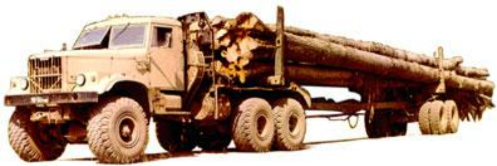
Лесовозный автомобиль-тягач КрАЗ-255Л1
