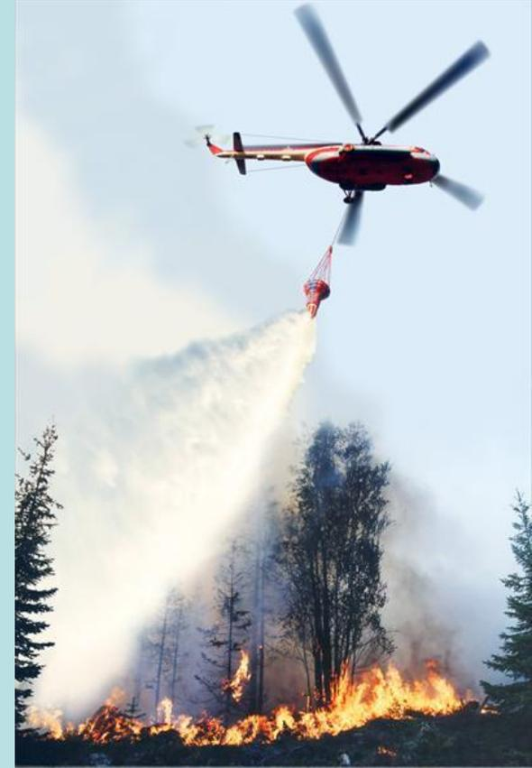
Все погрузочно-разгрузочные операции должны производиться в режиме зависания в воздухе на необходимой высоте (иногда до 50 м), чаще всего при отсутствии в данном пункте возможности принять на борт летательного аппарата балласт (воду, песок и др.).
