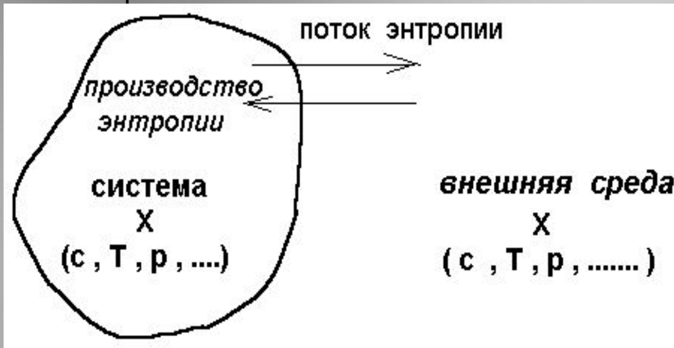
Рис. Схематическое представление открытых систем : производство и поток энтропии.
