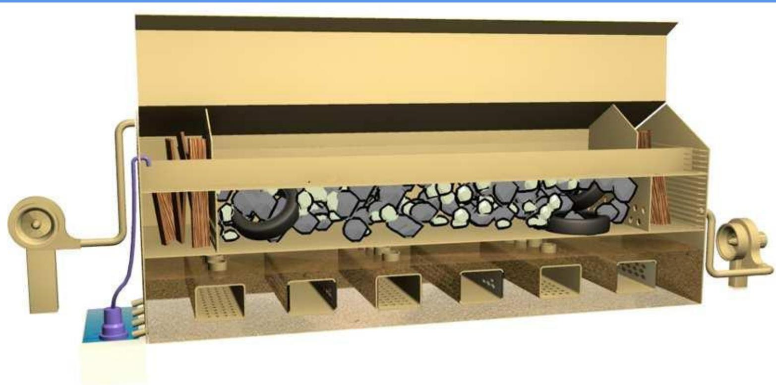
После загрузки ТБО и топлива (дров) подаётся вода в систему водяного затвора и орошения системы очистки дыма и включается подача воздуха в камеры сжигания.
