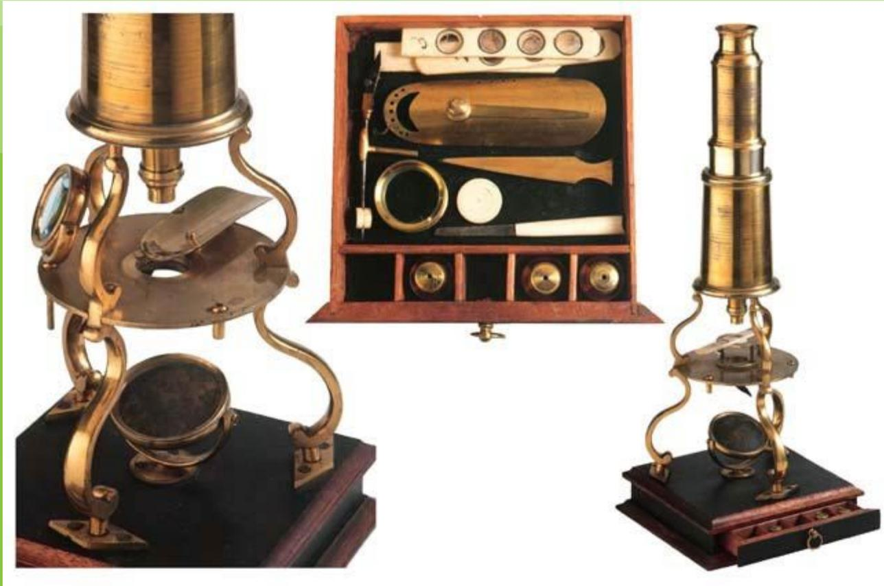
**Идея Х.Г. Гертеля об освещении прозрачных объектов снизу с помощью зеркала впервые воплотилась в жизнь в микроскопах Э. Кельпепера. С 30-х гг. XVIII в. он начинает выпускать треножную модель сложного микроскопа, под столиком которого располагалось зеркало. В состав микроскопа входило несколько объективов, дававших увеличение от 25 до 275 раз.**
