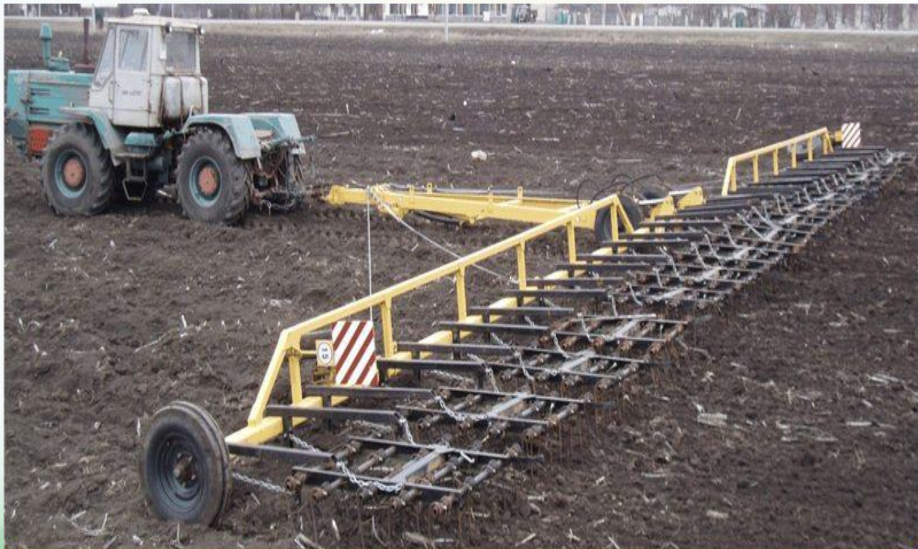
Трактор боронит землю железными зубьями бороны
