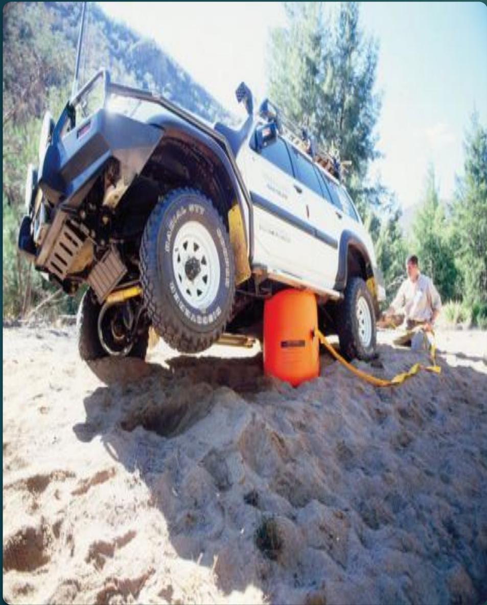
Расправляем домкрат, чтобы дно и верх были ровными и находились примерно друг над другом (иначе машину пододвинет). Подкладываем под колеса башмаки, один коврик на землю, второй кладем на домкрат. Все это помещаем между двумя колесами, чтобы поднять сразу одну сторону авто. Надеваем шланг на выхлопную трубу.
