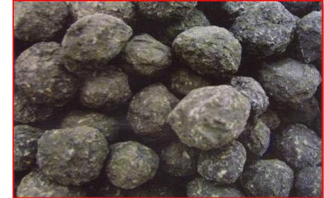
В цементной печи не образуется побочных производных и отходов (зола). Зола химически связывается с сырьевой смесью, и все, что получается в цементной печи, - клинкер
