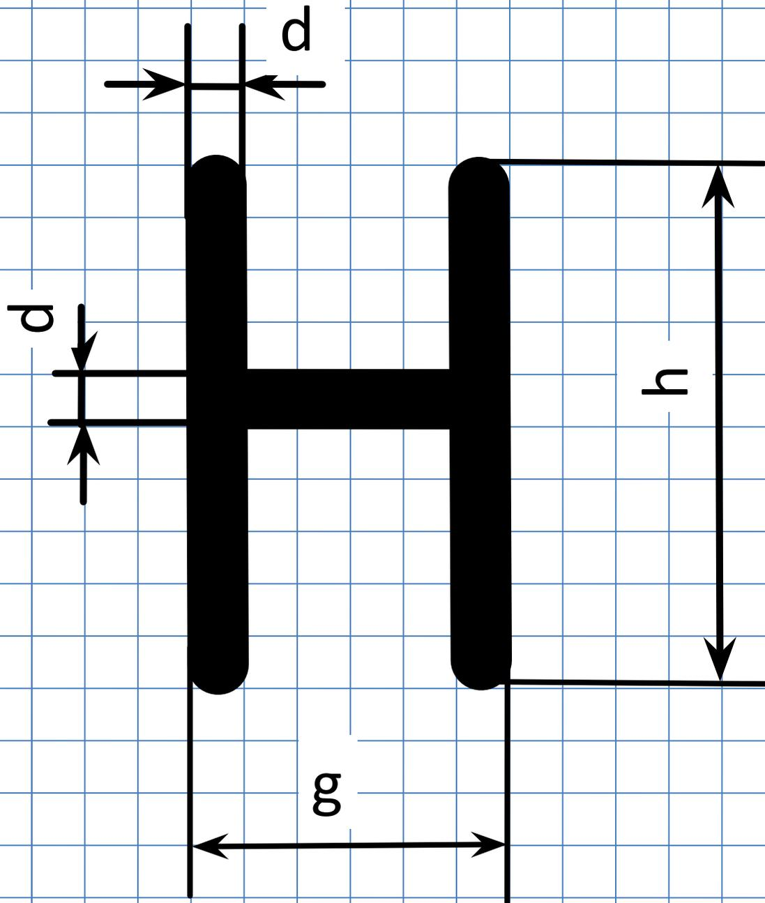
Толщину ( $d$ ) линии шрифта определяют в зависимости от высоты шрифта. Она равна  $0,1h$ .
