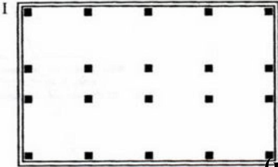
*Каркасная*, т. е. с несущими отдельными опорами. Состоит из вертикально поставленных стоек (колонн) и опирающихся на них балок (прогонов).
