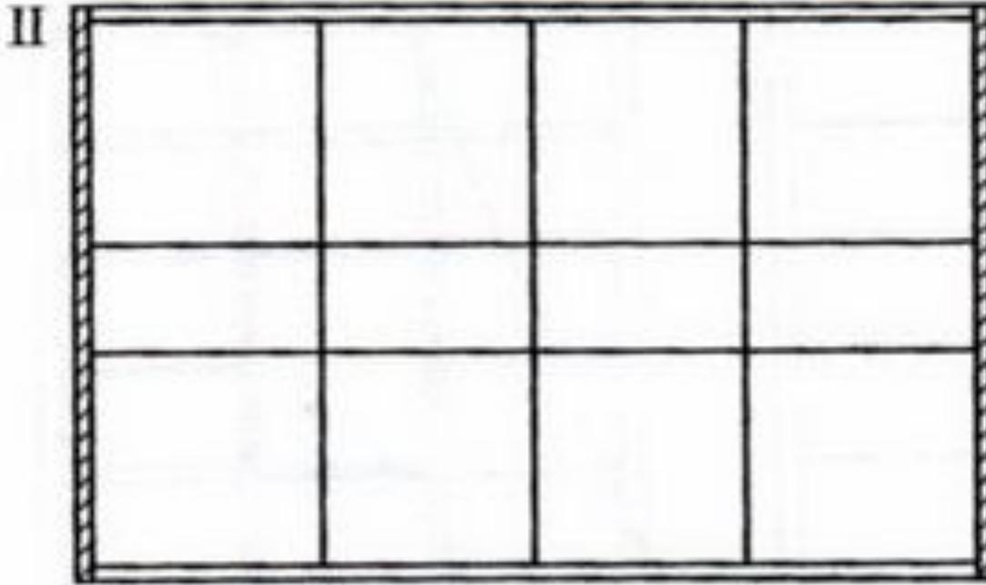
Зданиями *стеновой конструктивной схемы (бескаркасными)* (панельным или крупноблочным) называют здания, в которых вертикальные элементы komponуют из поставленных одну на другую стеновых панелей (блоков).
