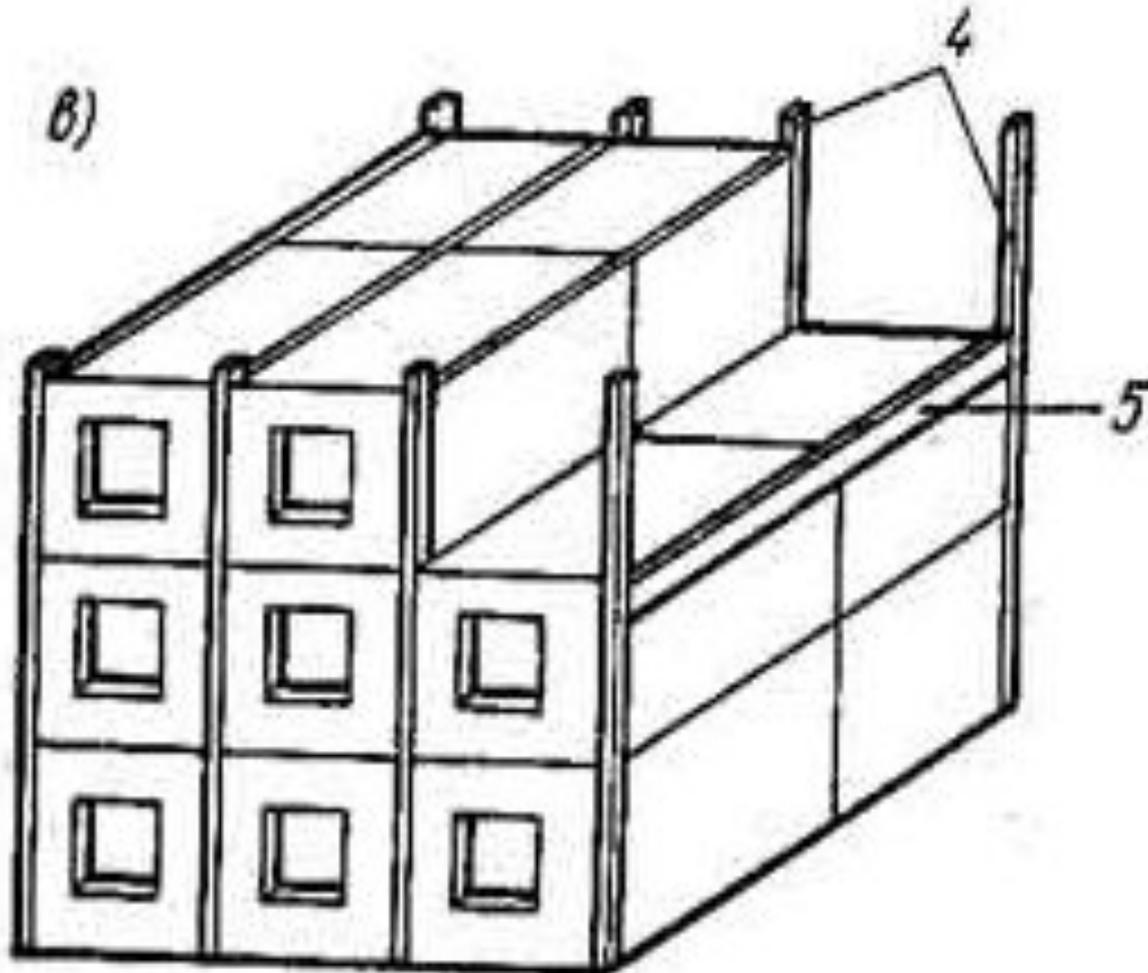
сочетание несущих объёмных блоков и плоскостных конструкций (стеновые панели, плиты перекрытий и др.).
