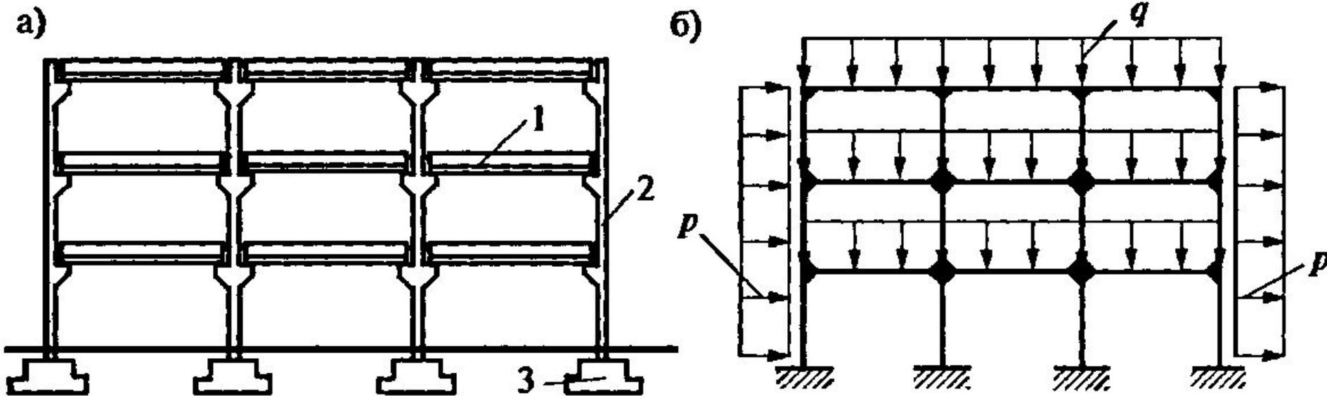
Рамная схема каркаса: а) конструктивная схема; б) расчетная схема; 1 — неразрезанный ригель; 2 — колонна; 3 — фундамент
