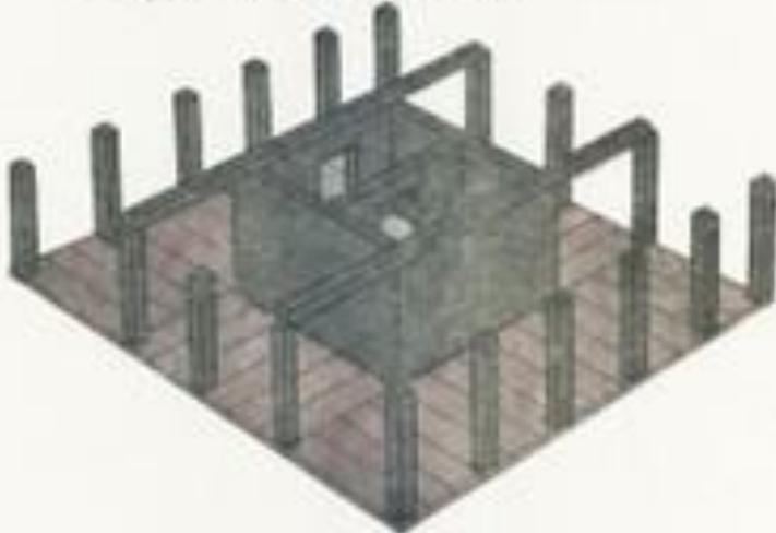
с монолитным ядром жесткости между секциями
