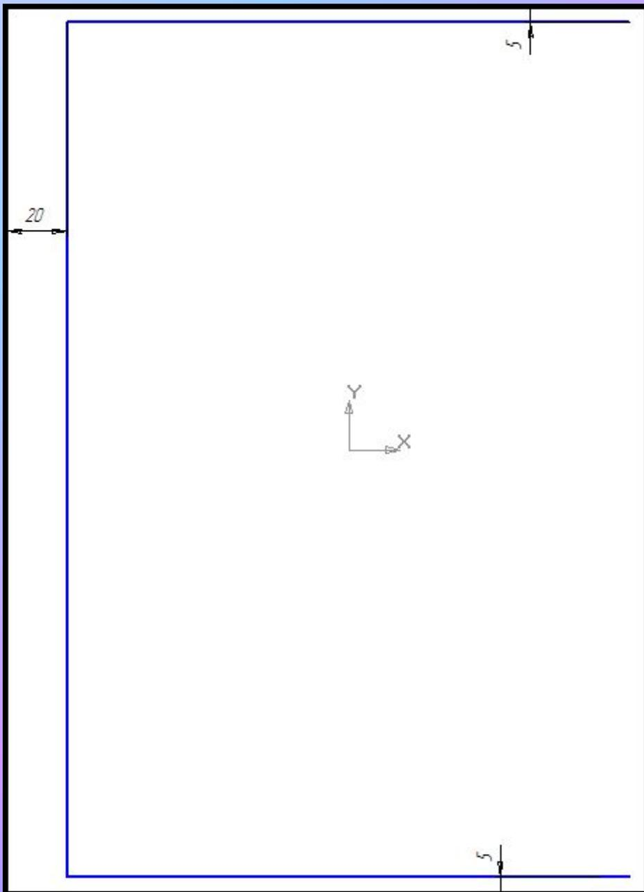
Провести линию параллельно нижней горизонтальной стороне на расстоянии 5 мм.
