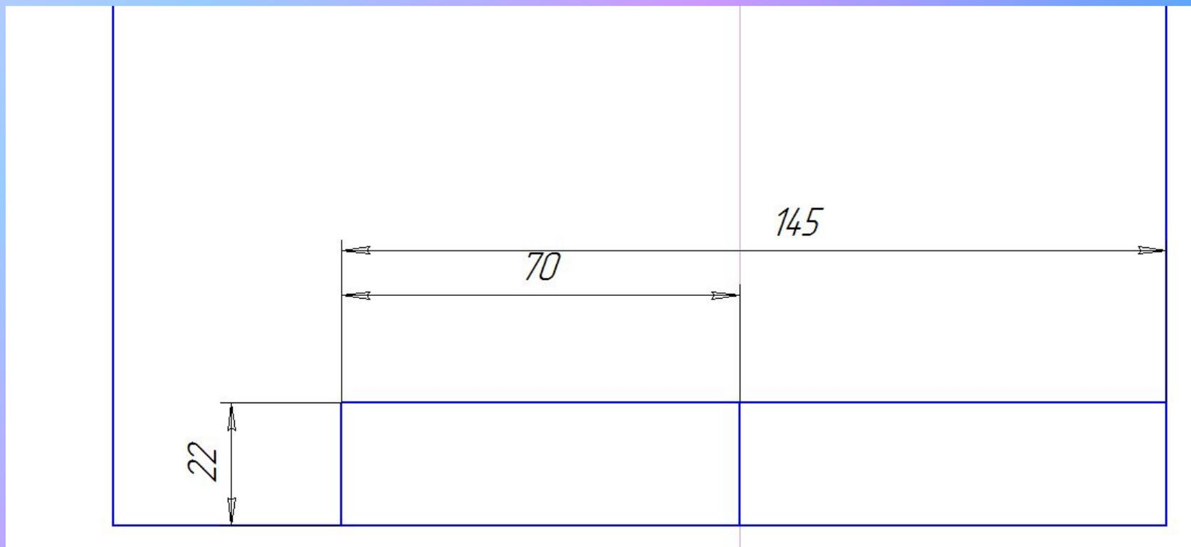
3. Провести вертикальную линию параллельно левой короткой стороне прямоугольника на расстоянии 70 мм.
