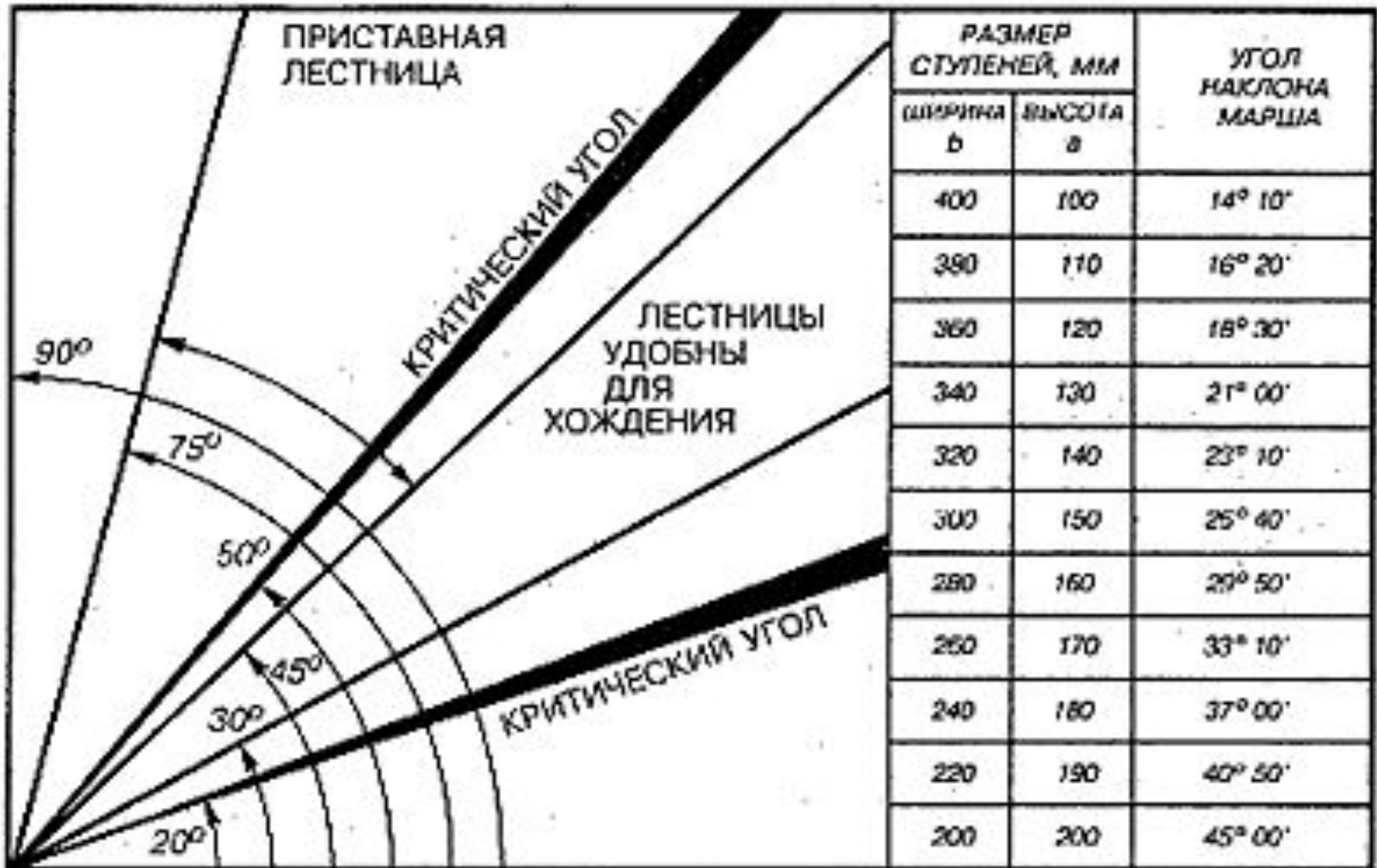
Рис. 3. Диаграмма соотношения между размерами ступеней и углом наклона марша.
