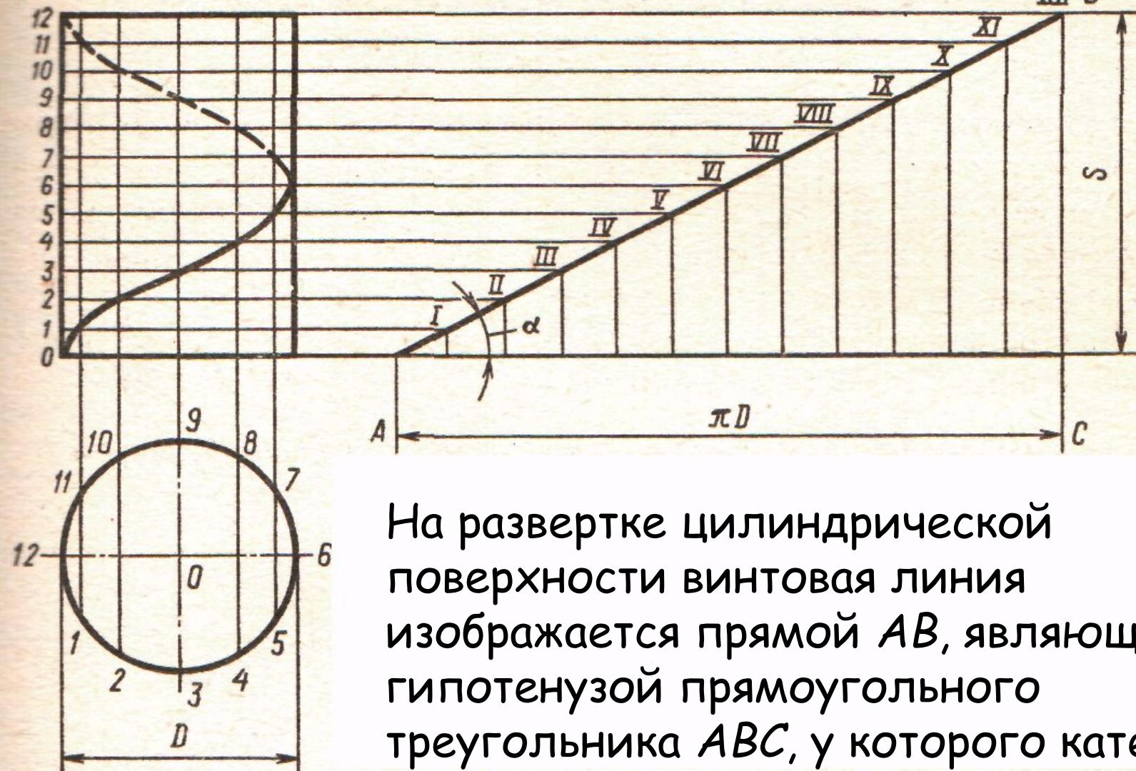
На развертке цилиндрической поверхности винтовая линия изображается прямой  $AB$ , являющейся гипотенузой прямоугольного треугольника  $ABC$ , у которого катет  $AC$  - длина окружности основания цилиндра, катет  $BC$  - ход винтовой линии. Угол  $\alpha$  - угол подъема винтовой линии.
