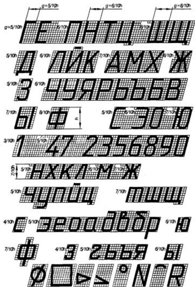
ШРИФТ ЧЕРТЕЖНЫЙ ТИПА Б ( d=1/10h ) С НАКЛОНОМ ОКОЛО 75^\circ (ГОСТ 2.304-81)
