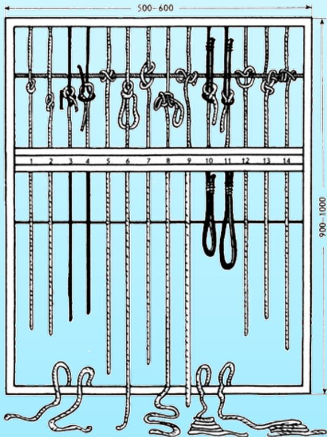
Кроме прямой практической пользы, вязание узлов представляет собою и очень своеобразную «гимнастику для ума». Пособие состоит из двух соединённых рамок с прутом в каждой. В верхней рамке завязаны 14 узлов (образцов), расположенных по мере роста их сложности, а в нижней — отрезки шнура, чтобы можно было сделать точные копии верхних узлов.
