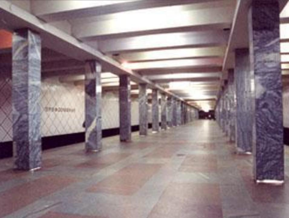
ПОСЛЕВОЕННЫЕ СТАНЦИИ СТРОИЛИСЬ ТАКЖЕ С УЧЕТОМ ВОЗМОЖНОСТИ ПРЕВРАЩЕНИЯ ИХ В БОМБОУБЕЖИЩА, НО УЖЕ В СЛУЧАЕ ЯДЕРНОГО, БАКТЕРИОЛОГИЧЕСКОГО ИЛИ ХИМИЧЕСКОГО УДАРА. ТАК ПОЯВИЛИСЬ СТАНЦИИ ГЛУБОКОГО ЗАЛОЖЕНИЯ. ВПРОЧЕМ, ГЕРМЕТИЧНЫМИ ДВЕРЯМИ ОБОРУДОВАНЫ ВЫХОДЫ ВСЕХ СТАНЦИЙ И ТОННЕЛИ, ВЕЗДЕ ЕСТЬ ДИЗЕЛЬНЫЕ ЭЛЕКТРОСТАНЦИИ И ВЕНТИЛЯЦИОННЫЕ ШАХТЫ С ФИЛЬТРАМИ.
