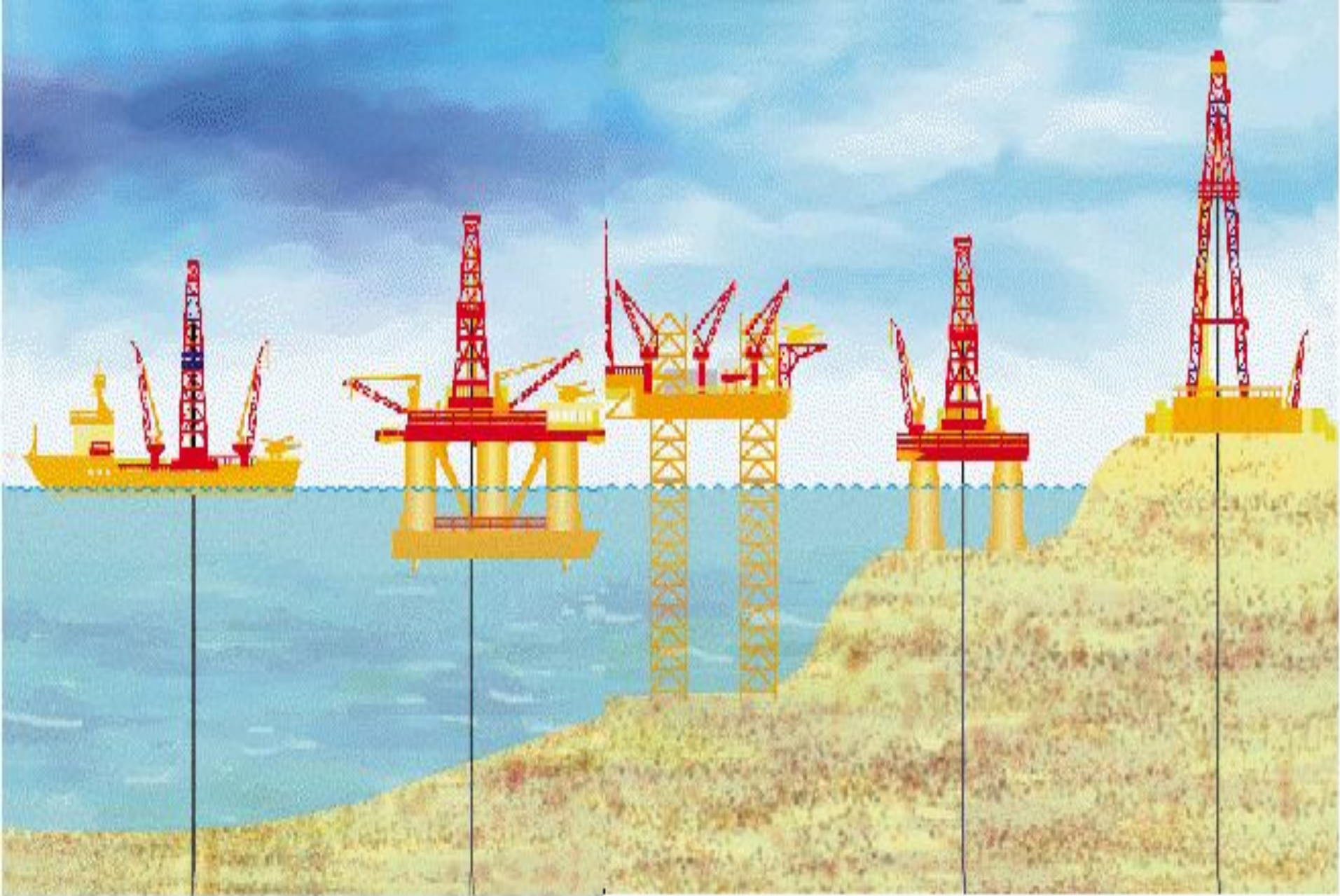
Рис. 4. Виды буровых скважин
