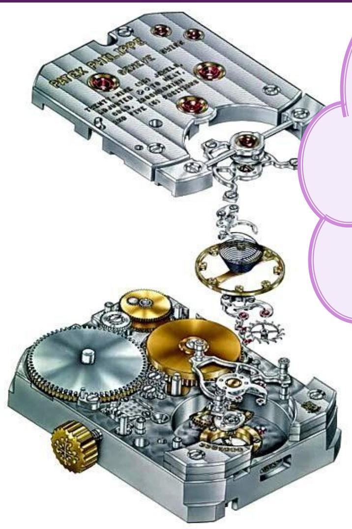
Прошло много времени с тех пор, когда человек придумал часы с механическим механизмом. Внутри часов поставил пружину, закрутил её, а чтобы она раскручивалась, прикрепил к ней зубчатое колёсико. Оно цепляется за другое колёсико и вертит его. Второе же колёсико вертит стрелки.
