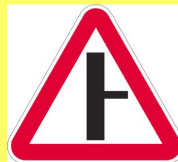
Примыкание второстепенной дороги
