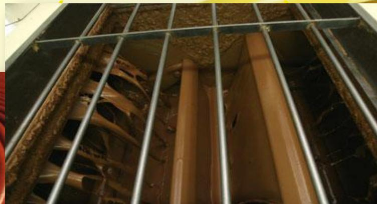
Разогретую шоколадную массу охлаждают, а потом опять нагревают. Это даёт гладкую поверхность и блеск шоколадной плитке. Затем шоколад разливают в специальные формы. Где он твердеет.
