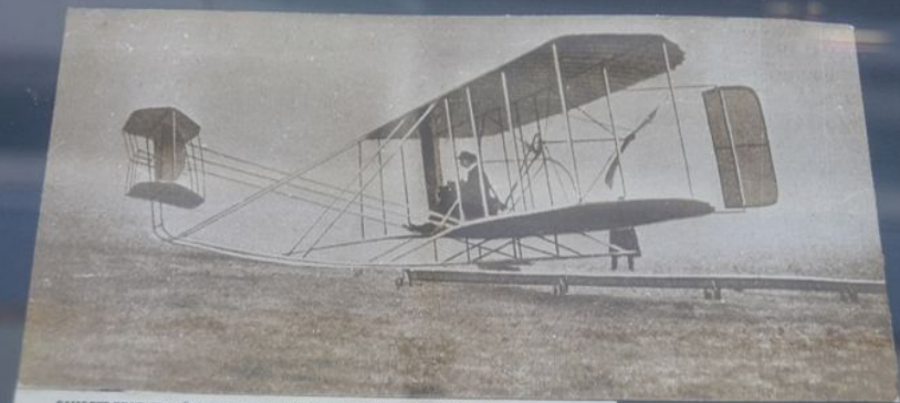
САМОЛЕТ БРАТЬЕВ РАЙТ (1903 г.). РАЗМАЗ КРЫЛА — 12,3 м, ПЛОЩАДЬ КРЫЛА — 47 кв. м, ВЗЛЕТНЫЙ ВЕС — 340 кг, МОЩНОСТЬ ДВИГАТЕЛЯ — 12 л.с.
