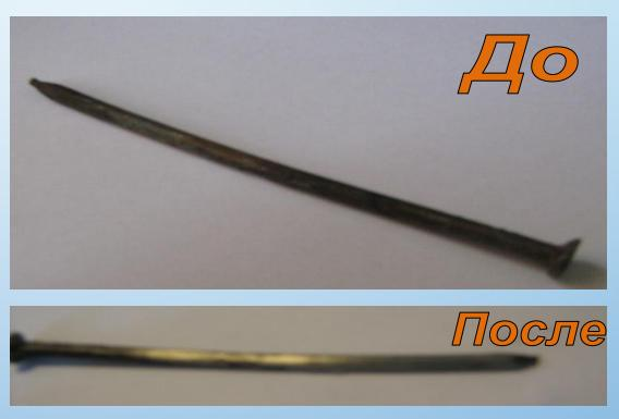
**ВЫВОД:** КОКА-КОЛА РАЗЪЕДАЕТ РЖАВЧИНУ! ОРТОФОСФОРНАЯ КИСЛОТА ПОМОГАЕТ УДАЛЯТЬ РЖАВЧИНУ, МАСЛЯНУЮ КРАСКУ И БЫТОВЫЕ ЗАГРЯЗНИТЕЛИ С МЕТАЛЛИЧЕСКИХ ПРЕДМЕТОВ.
