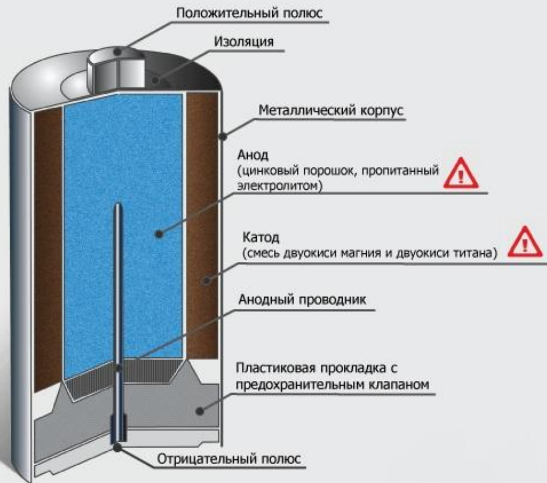
Строение обычной батарейки
