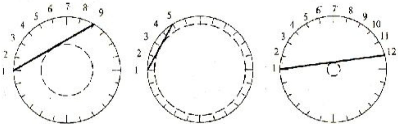
От длины хорды зависит размер внутренней незаполненной окружности: чем длиннее хорда, тем более заполненной получается окружность. Изменяя количество точек деления окружности и длину хорды, можно получить различные варианты заполнения окружности.
