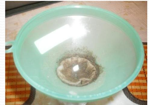
Я взял стакан с грязной водой и вылил в воронку, вода медленно капала в стакан. В результате в стакане вода стала чистой, а грязь и примеси остались на вате.
