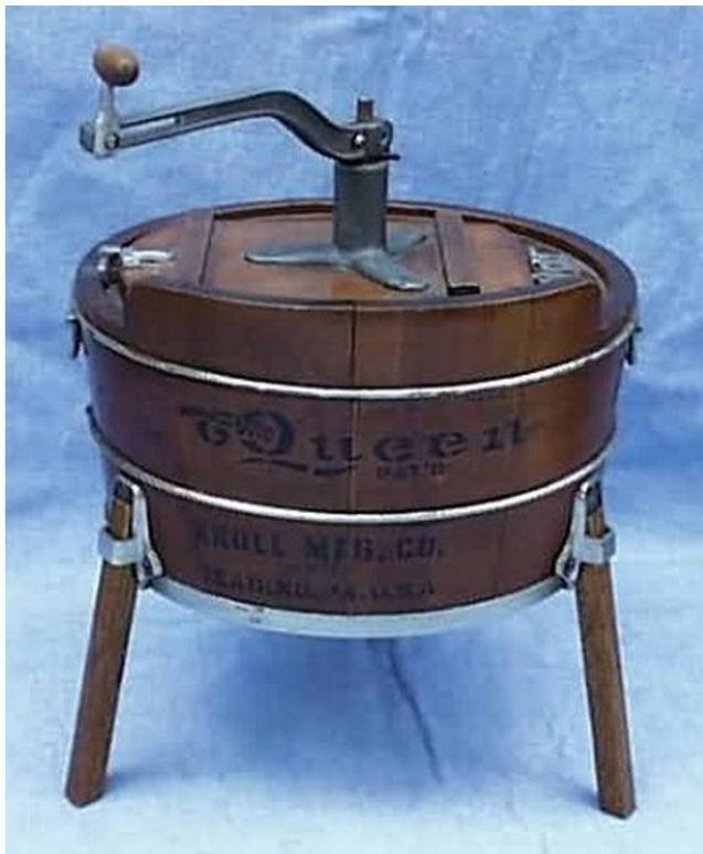
**Белье загружалось в бочку, заливалось горячей водой с мыльным раствором, бочка закрывалась крышкой и с помощью ручки крестовина вручную вращалась внутри бочки**
