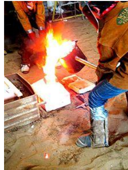
Ручная заливка металла в форму
