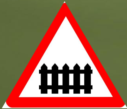
железнодорожный переезд со шлагбаумом
