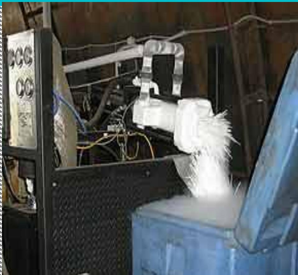
и очень холодный газ. Затем снег прессуют под давлением 30-50 атмосфер и получают сухой лед, а газ откачивают, сжижают и возвращают в резервуар для хранения. Современные установки выпускают сухой лед в виде крошки, гранул и брикетов.
