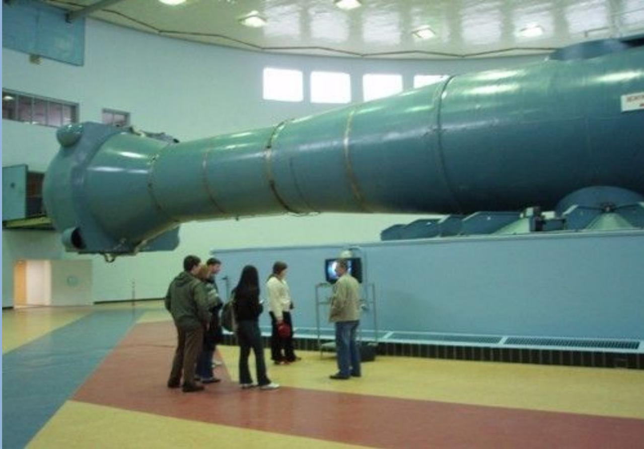
В этой огромной, 18-метровой кегле создаются перегрузки, которые космонавт испытывает во время полета. Сама она вращается по кругу, голова ее тоже вращается, внутри головы вращается кабина, а внутри кабины вращается кресло с космонавтом.
