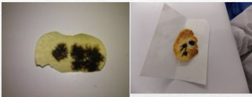
Фото 1. Капнули йод и наблюдали образование темно-синего пятна, что свидетельствует о наличии крахмала в чипсах)
