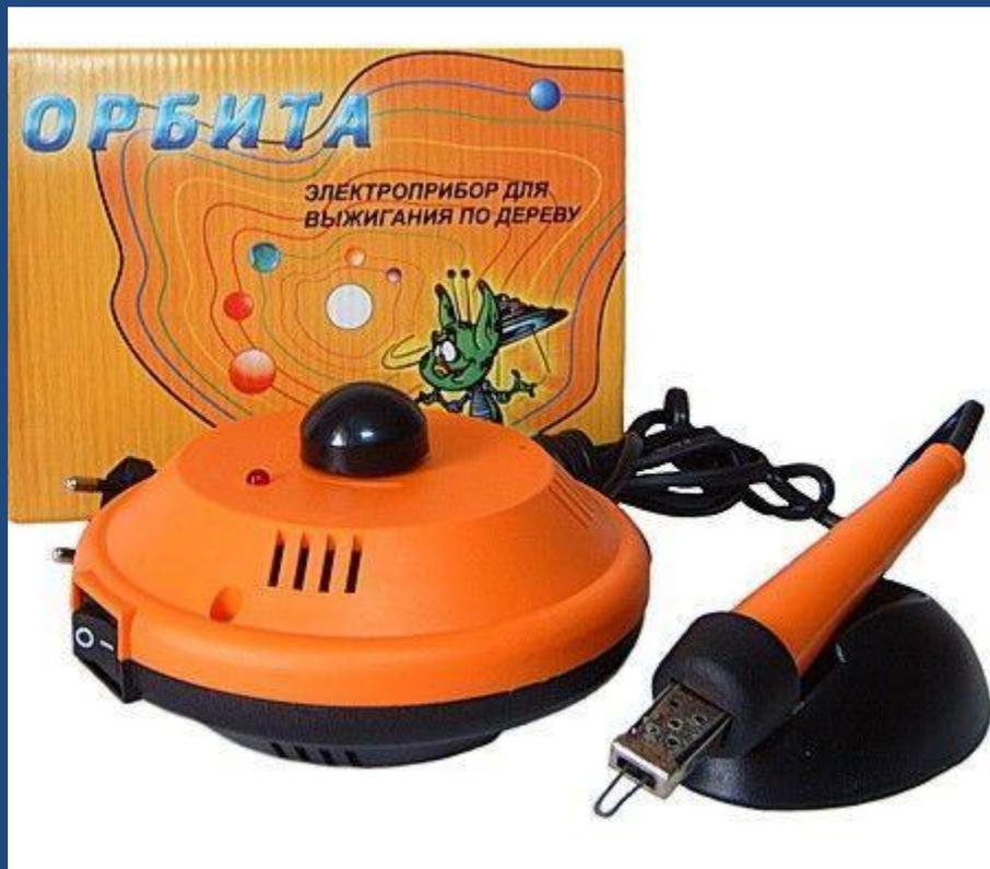
Простейший электровыжигатель состоит из понижающего трансформатора, реостата, ручки и сменных нитей накала, которые называют штифтами. Вместо реостата лучше применять лабораторный трансформатор — ЛАТР. Он наиболее удобен в работе и позволяет получать высококачественный выжиг различной тональности — от светло-охристого до темно-коричневого.
