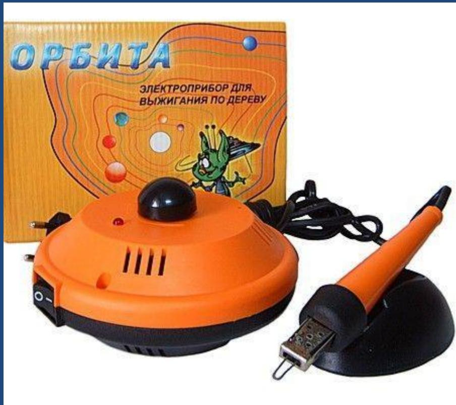
Простейший электровыжигатель состоит из понижающего трансформатора, реостата, ручки и сменных нитей накала, которые называют штифтами. Вместо реостата лучше применять лабораторный трансформатор — ЛАТР. Он наиболее удобен в работе и позволяет получать высококачественный выжиг различной тональности — от светло-охристого до темно-коричневого.
