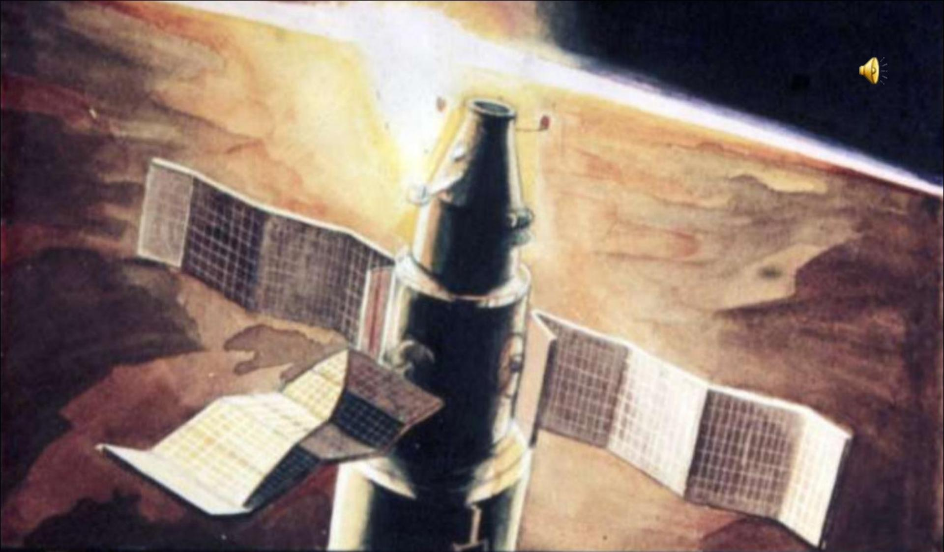
По сторонам корпуса, как крылья, протянулись пластины солнечных батарей. Это местная электростанция. Она превращает энергию Солнца в электричество, обогревает и освещает станцию.
