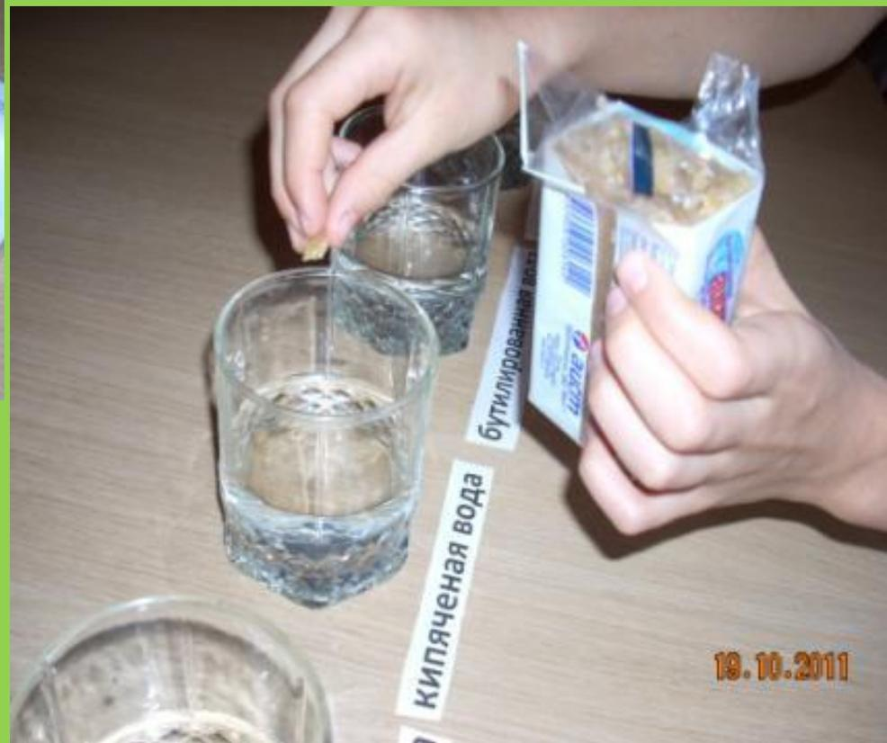
Везде получился мутный раствор, кроме стакана с жесткой водой. Здесь вода осталась прозрачной
