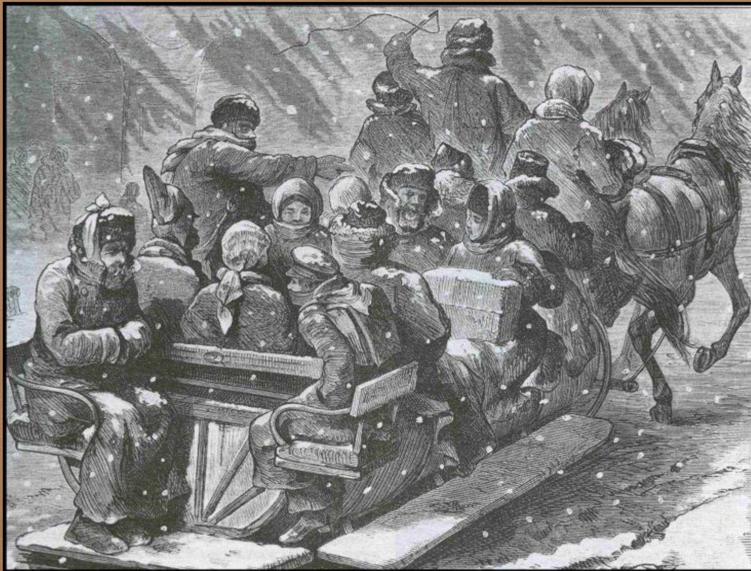
Позже для зимнего времени года был разработан новый вид экипажа. Это был обыкновенный, малого размера, **вагон - сани** на санных полозьях. Внутри вагона 14 мест, по семи на каждой стороне. Кондуктор стоит позади на деревянной площадке, у дверей сделаны ручки для удобства при входе в вагон.
