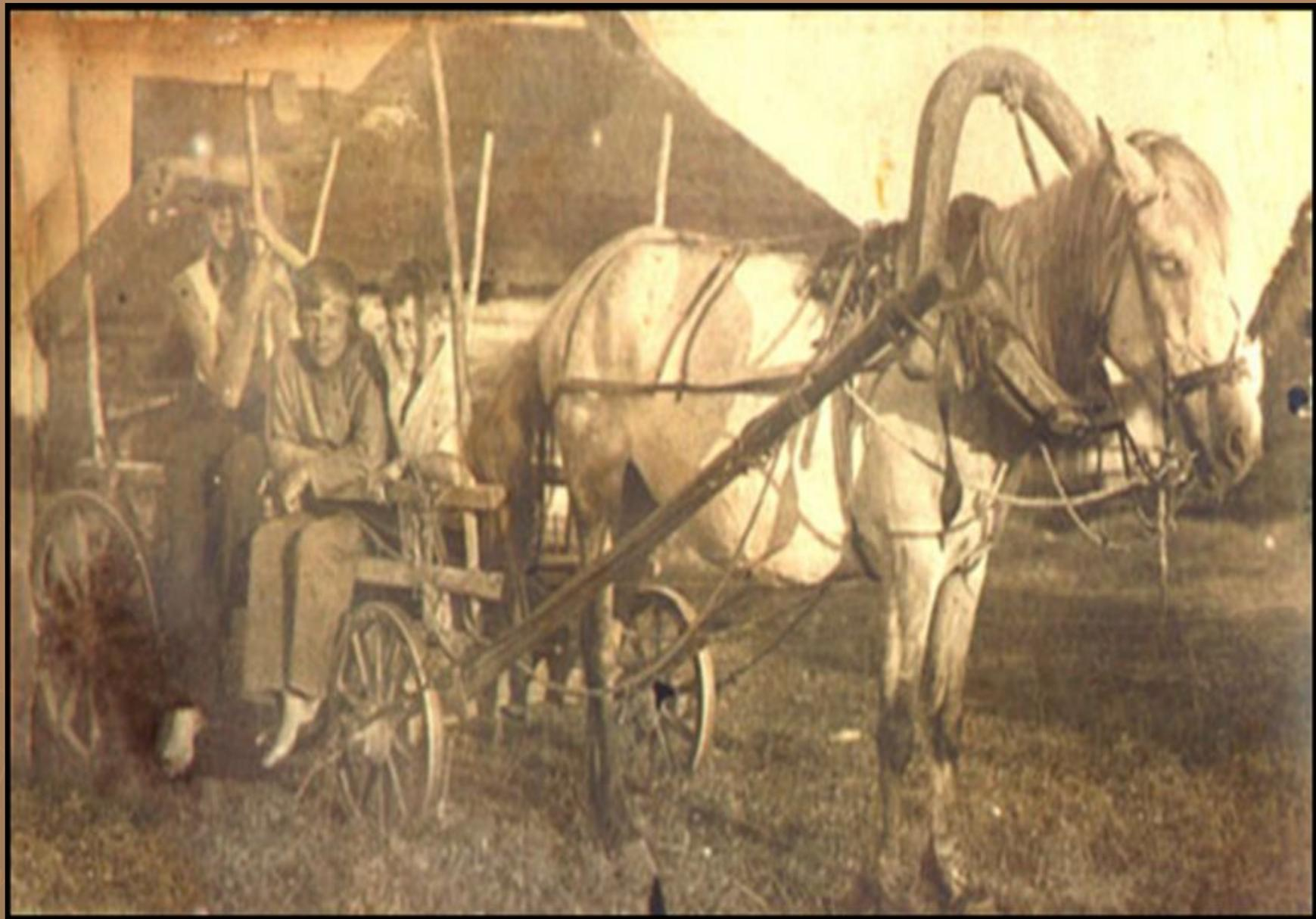
Другой разновидностью телеги был **полок** —одноконная кузовная повозка для перевозки затаренных грузов.
