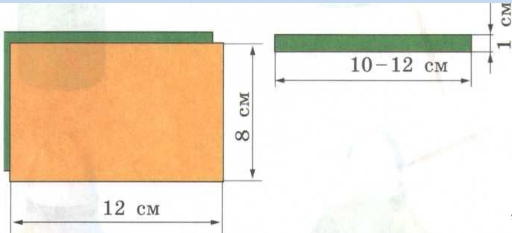
**2.** Подготовим внешнюю деталь фонарика. Надрезы делайте точно до линии сгиба. Расстояния между надрезами должны быть одинаковыми и небольшими (около 5 мм).
