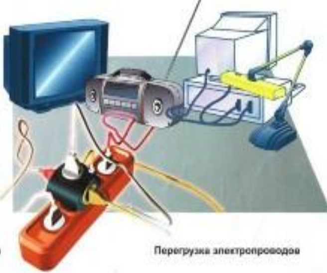
Неисправность электропроводки Пользование самодельными предохранителями
