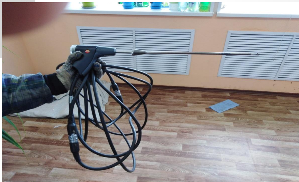
Чувствительный элемент газоанализатора
