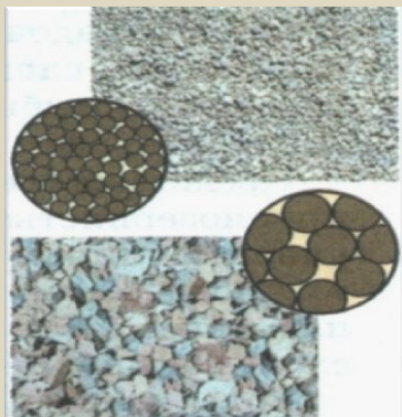
Рис.53 От размеров частиц породы зависит размер пор, в которые проникает вода
