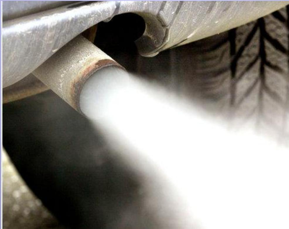
В атмосферу выбрасываются вредные вещества: оксид углерода, оксиды серы, азота, соединения свинца, сажа, углеводороды, бензапирен C<sub>20</sub>H<sub>12</sub>, несгоревшие частицы топлива.
