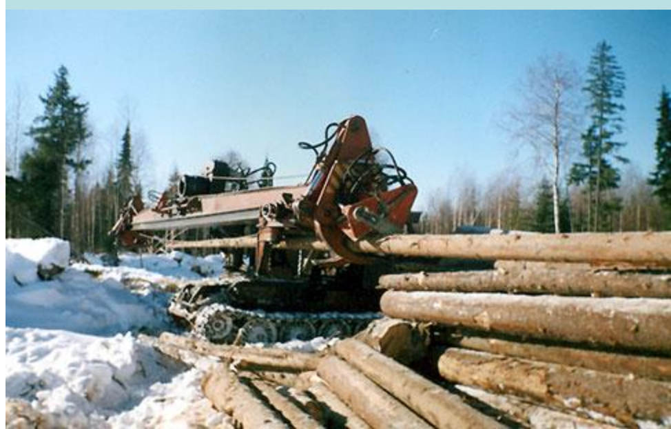
Сучкорезно-раскряжевочная машина ЛМ-1
