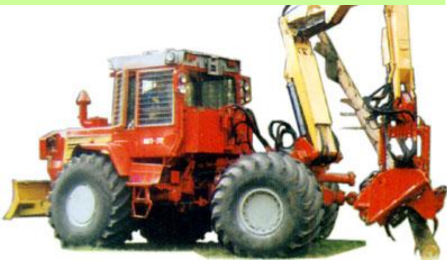
Валочно-сучкорезно-раскряжевочная машина МЛ-72
