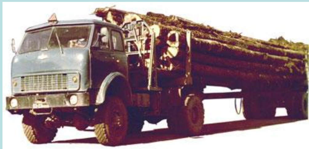
Лесовозный автомобиль-тягач МАЗ-509А
