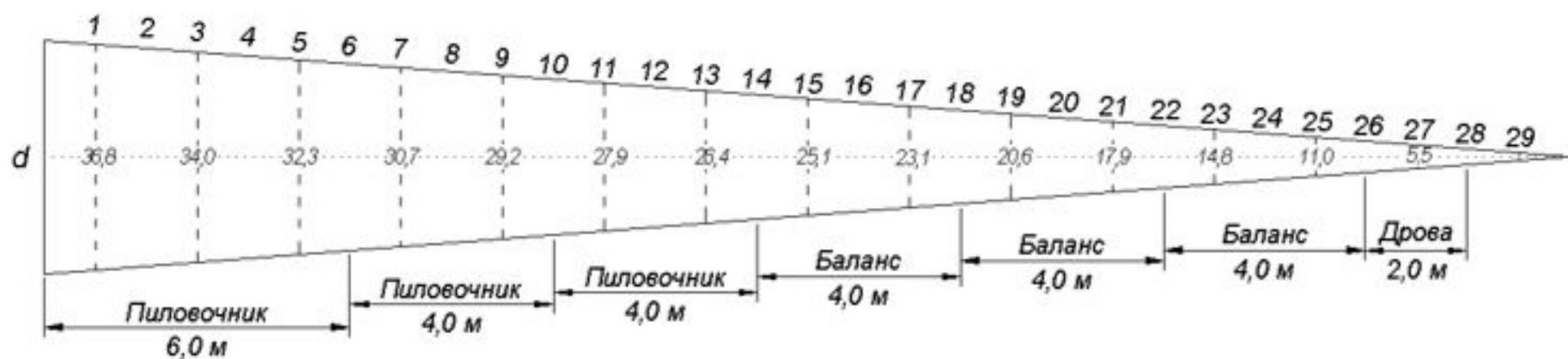
Рисунок 12 – Схема разделки ствола на сортименты для D_{1,3(в/к)} = 40 см
