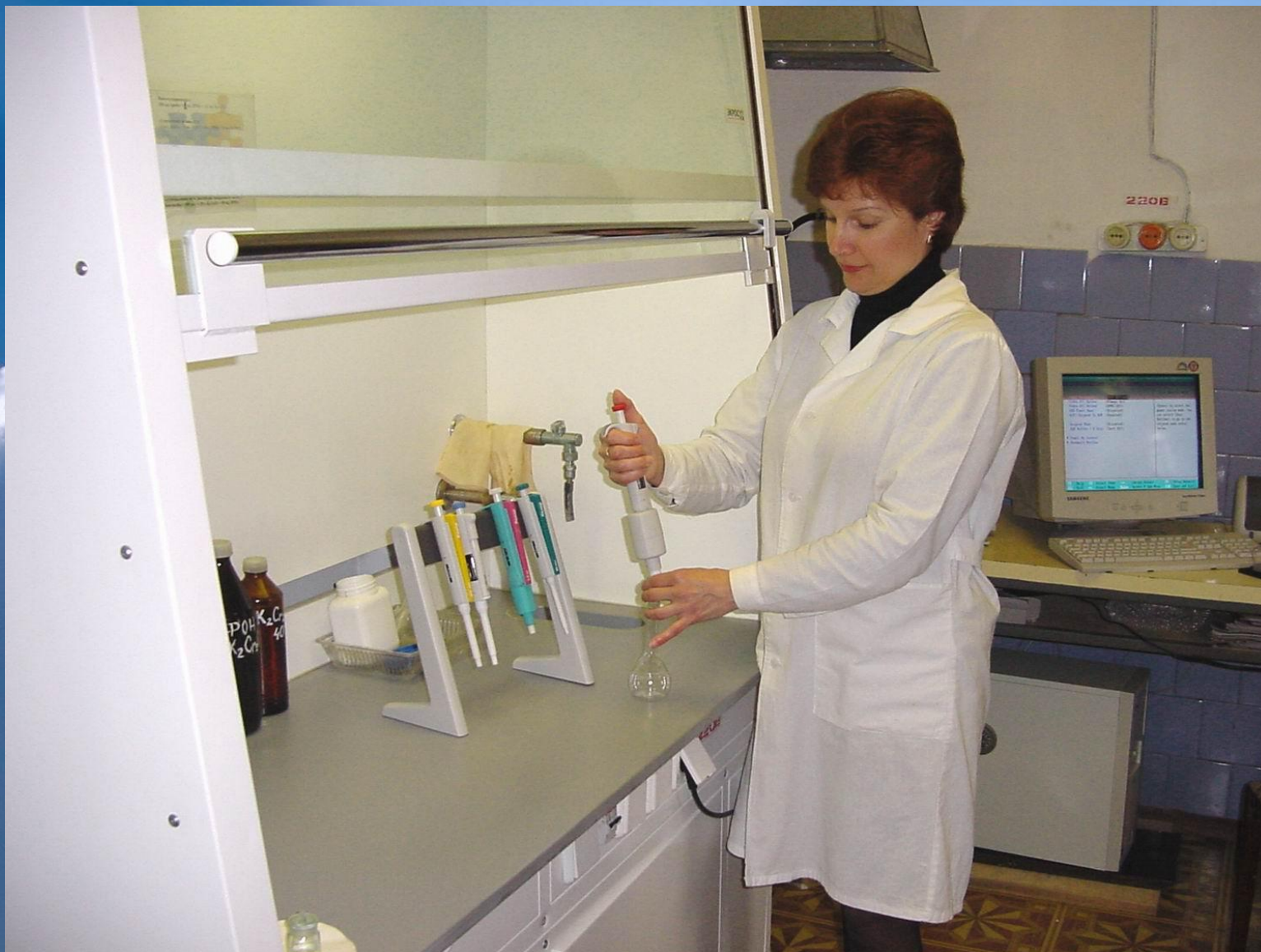
Подготовка пробы природной воды для определения ртути на спектрометре «КВАНТ-2А-ГРГ»
