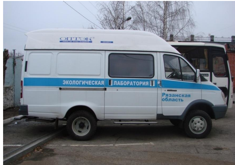
Передвижная экологическая лаборатория контроля качества воздуха ( \text{CO} , \text{NO} , \text{NO}_2 , \text{H}_2\text{S} , \text{O}_3 , пыль)
