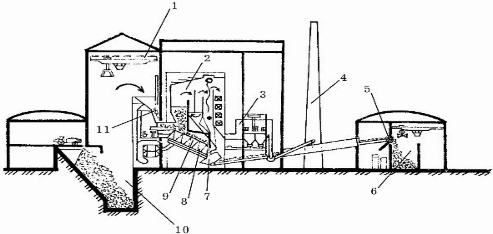
Схема мусоросжигательного завода: 1 – мостовой кран с ковшом; 2 – парогенератор; 3 – электрофильтр; 4 – дымовая труба; 5 – сепаратор; 6 – склад шлака; 7 – механизм шлакоудаления; 8 – подпорный валик колосниковой решетки; 9 – обратно переталкивающая колосниковая решетка; 10 – приемный бункер; 11 – бункер котлоагрегата.
