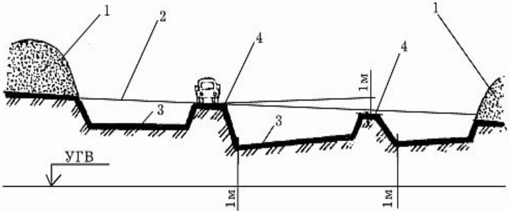
Схема размещения полигона на плоском участке: 1 – кавальер грунта для изолирующих слоев; 2 – уровень поверхности участков до создания котлованов, 3 – горизонтальное основание; 4 – промежуточный вал; УГВ – уровень грунтовых вод.
