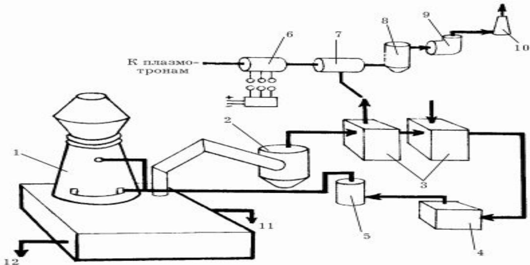
Схема плазменного способа переработки бытовых отходов: 1 – печь; 2 – циклон; 3 – теплообменники; 4 – компрессор; 5 – ресивер; 6 – электрогенератор; 7 – газотурбинный двигатель; 8 – скруббер; 9 – дымосос; 10 – дымовая труба; 11 – выход жидкого шлака; 12 – выход жидкого металла.
