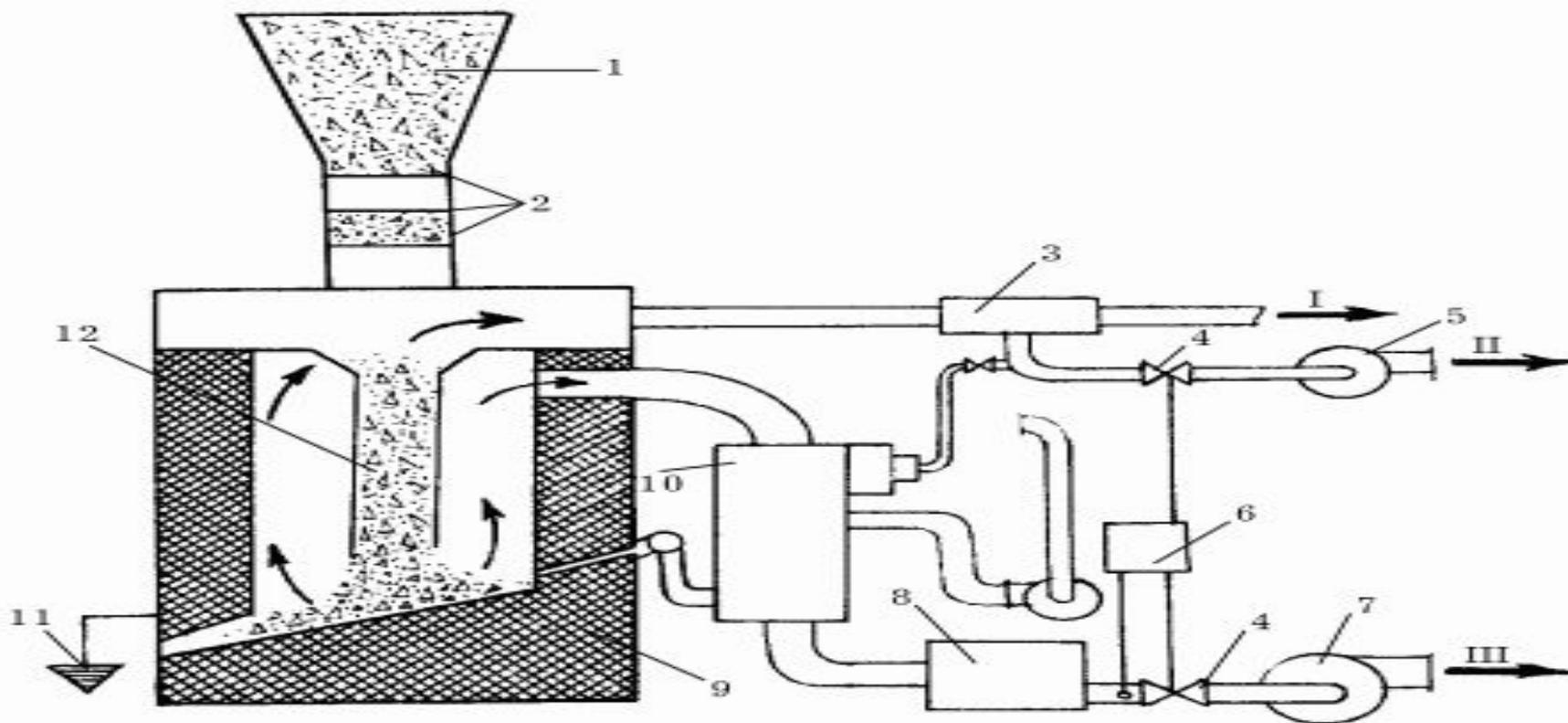
Оборудование для пиролиза: 1 – приемная воронка; 2 – затвор; 3 – конденсатор жидких продуктов; 4 – заслонки; 5 – вентилятор; 6 – газоанализатор; 7 – дымосос; 8 – система газоочистки; 9 – сопло подогретого воздуха; 10 – воздухоподогреватель; 11 – водяная ванна; 12 – швельшахта.
