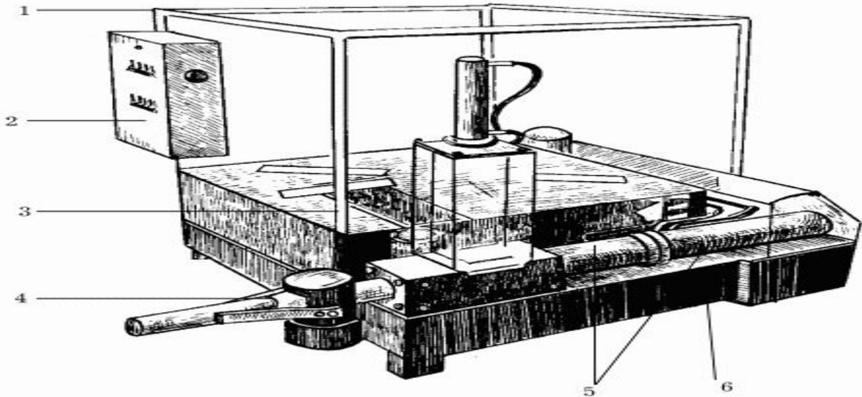
Оборудование для брикетирования бытовых отходов: 1 – загрузочный бункер-накопитель; 2 – панель управления процессом брикетирования; 3 – непрерывная подача материала с дозатором и транспортным шнеком; 4 – гидравлическое управление для поддержания плотности брикета при смене материала; 5 – камера прессования с двумя компрессорами и сенсорами, контролирующими все параметры для оптимального режима прессования; 6 – компактная конструкция для достижения максимальной стабильности.
