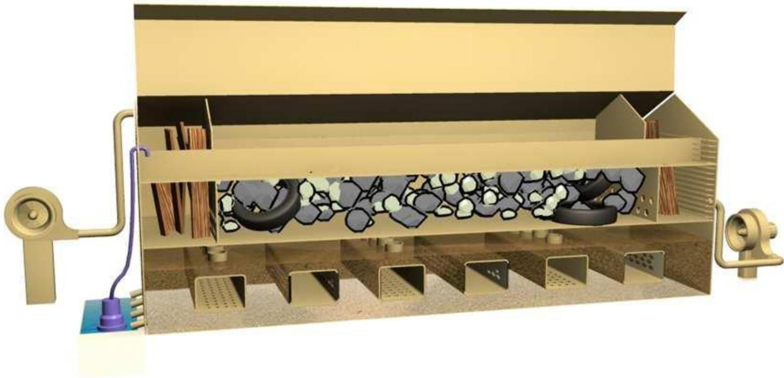
После загрузки ТБО и топлива (дров) подаётся вода в систему водяного затвора и орошения системы очистки дыма и включается подача воздуха в камеры сжигания.
