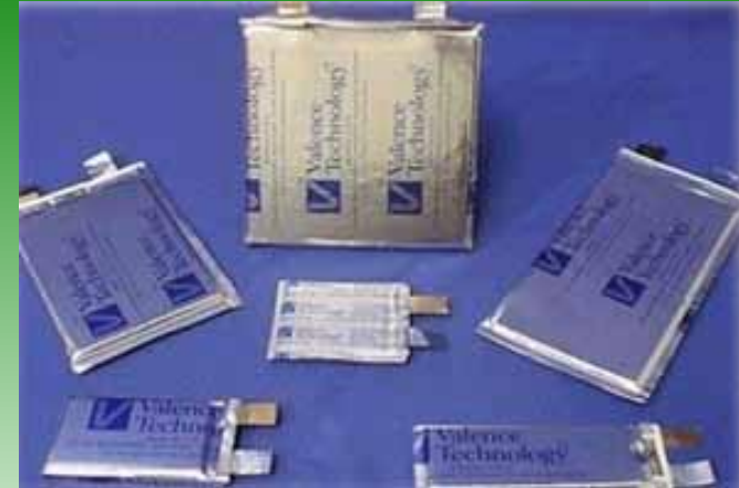
ОЛИА в мягком корпусе фирмы Valence.
